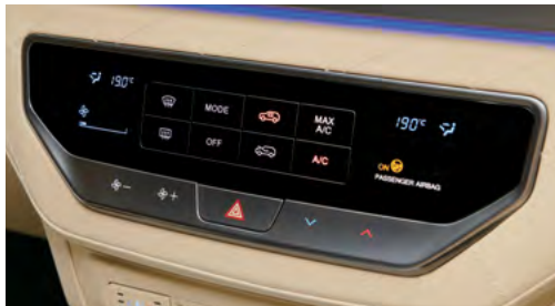
Aer condiționat manual
